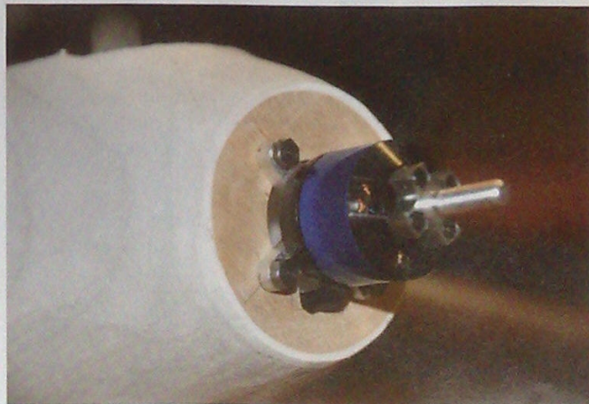
Motoreinbau, ein großflächiger Spant überträgt die Kräfte
